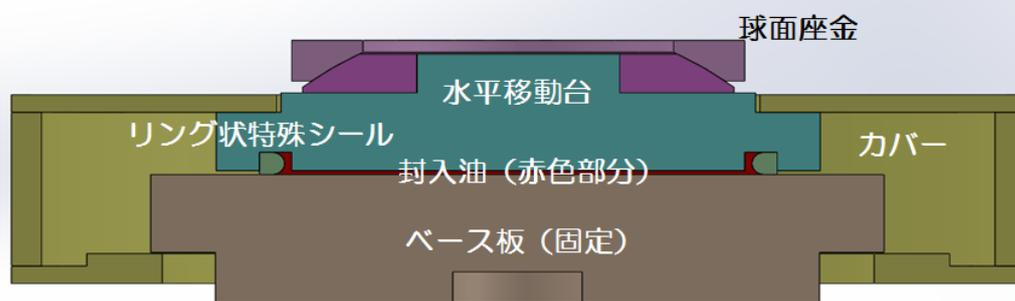
ベース板上の封入油を介して水平移動台がスライドします。
